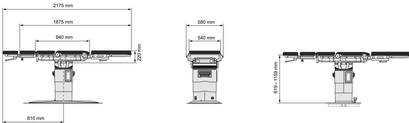
Размеры и диапазон высоты столешницы, информация относится к универсальной столешнице 1150.30
