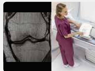
Высокое качество изображений с использованием 16-канальной гибкой катушки с технологией Speeder (время сбора каждой импульсной последовательности менее 3 минут)
