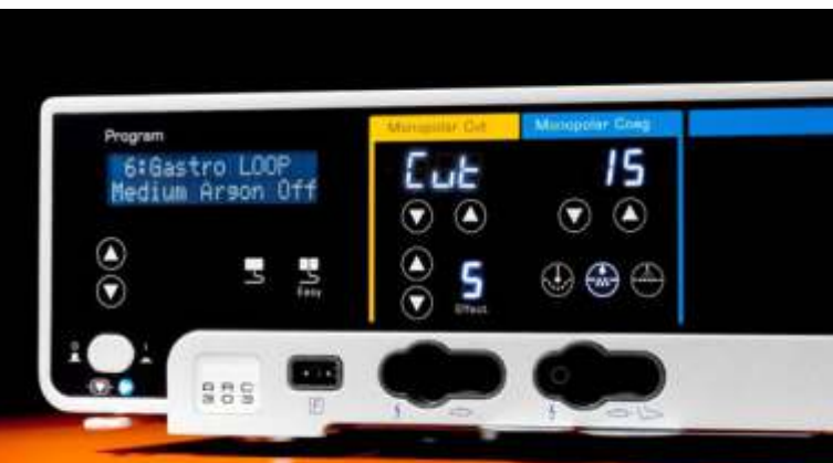
Функция GastroCut обеспечивает защиту от перфорации при полипэктомии, папиллотомии или эндоскопической резекции с помощью петель или электродов-игл
