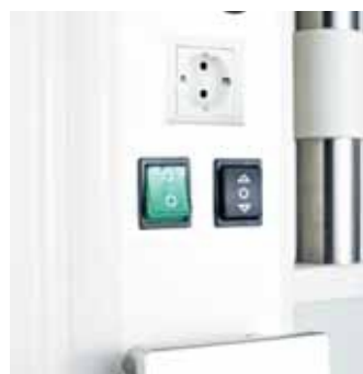
Модуль управления подъемом 2: кнопка управления на панели распределителя
