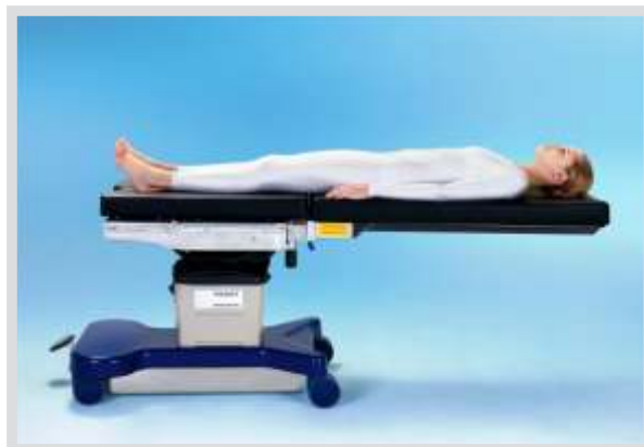
Беспрепятственный доступ для исследования с помощью С-дуги, благодаря отсутствию поперечных металлических элементов столешницы операционного стола и специальные фиброкарбоновые секции
