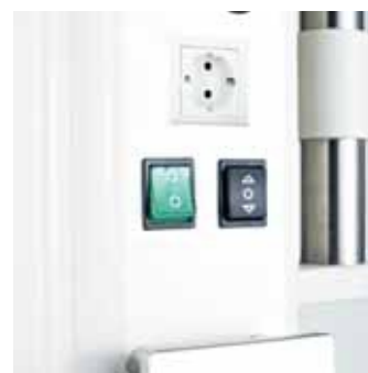
Модуль управления подъемом 2: кнопка управления на панели распределителя
