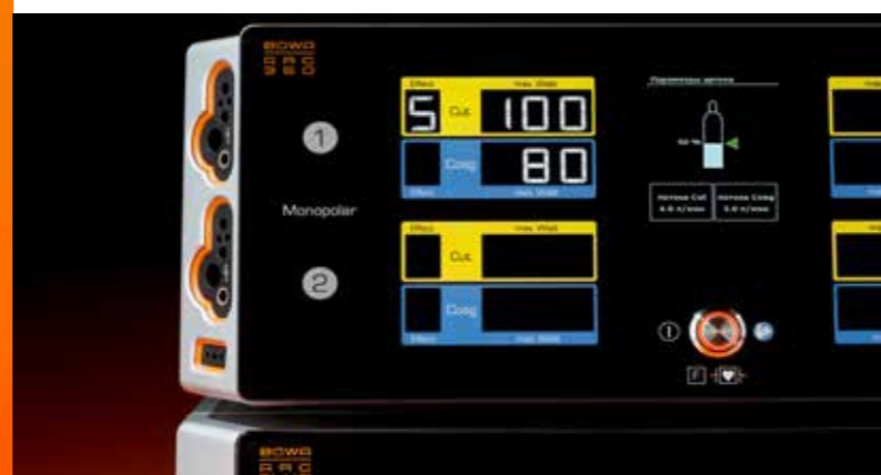
Параметры аргона устанавливаются непосредственно на ARC 350
