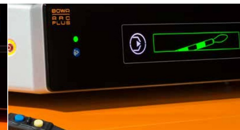
Зеленый цвет индикатора сигнализирует о предварительном промывании аргоном подсоединенных инструментов
