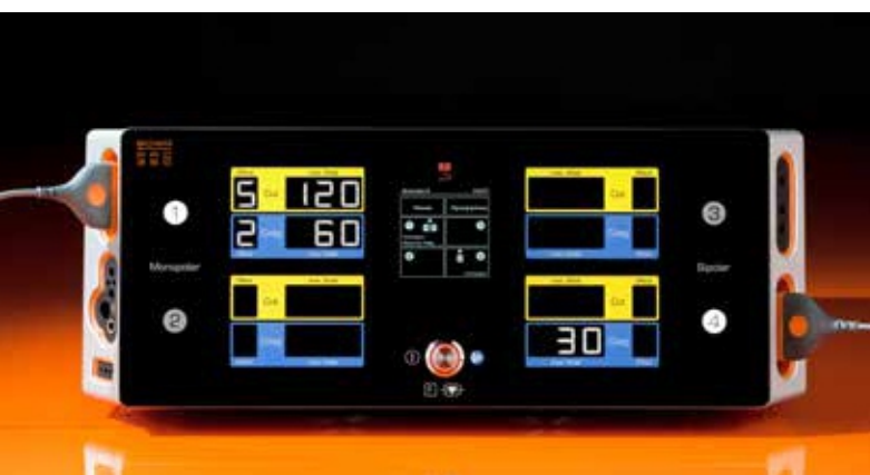
Наглядно: каждый подключенный разъем, на изображении это верхний левый и нижний правый разъемы, соотносен с определенным квадратом экрана
