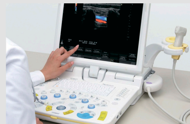
Сенсорная панель встроена в монитор изображения. Основные операции, такие как настройка качества изображения, могут выполняться прямым касанием. Дисплей может быть настроен так, чтобы отображались только те параметры, которые необходимы для ситуации, чтобы обеспечить бесперебойную работу систем
