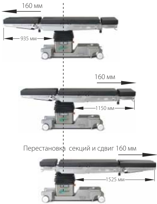
Продольный сдвиг панели (320 мм, с пульта), перестановка головной и ножной секций
