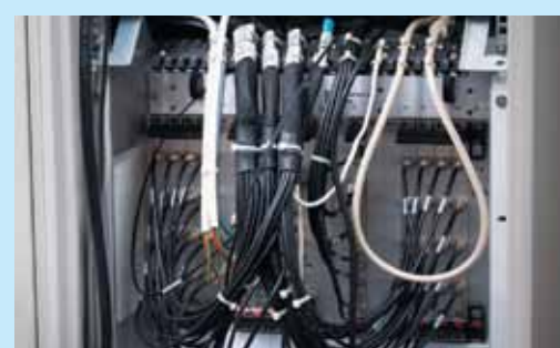
Другие системы МРТ: большая стойка с электроникой вне катушки.
